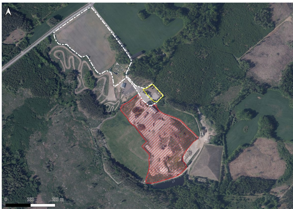
Figur 1. Översikt Mörkeskog avfallsanläggning. Vit streckad linje visar framtida anläggning med ny ÅVC och OLS (gul linje), samt ungefärlig yta för nuvarande anläggning som ska sluttäckas (rödskräfferad). Nuvarande ÅVC finns inom del av det rödskräfferade området.
