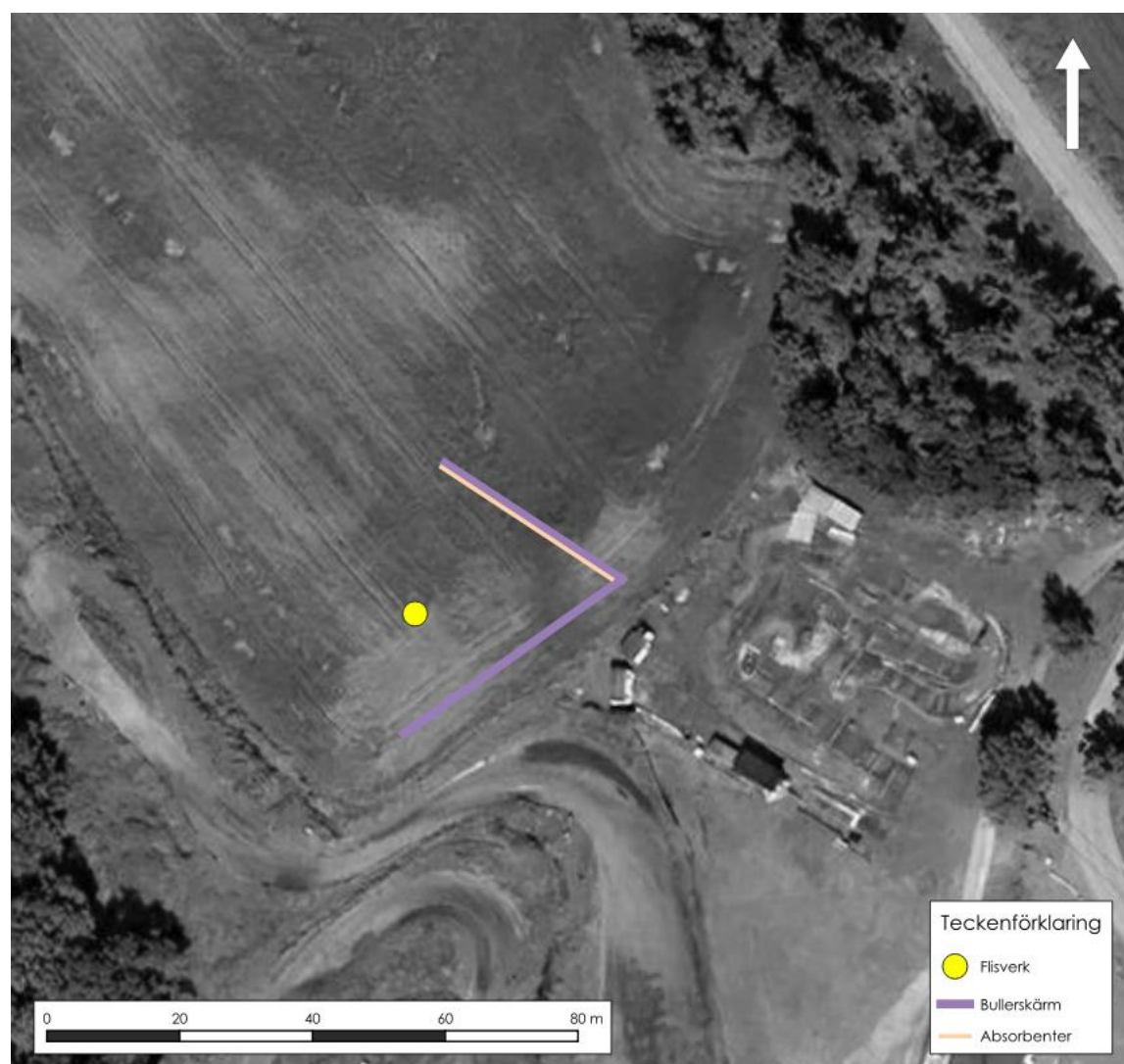
Figur 2. Bullerskärm vid flisning.
