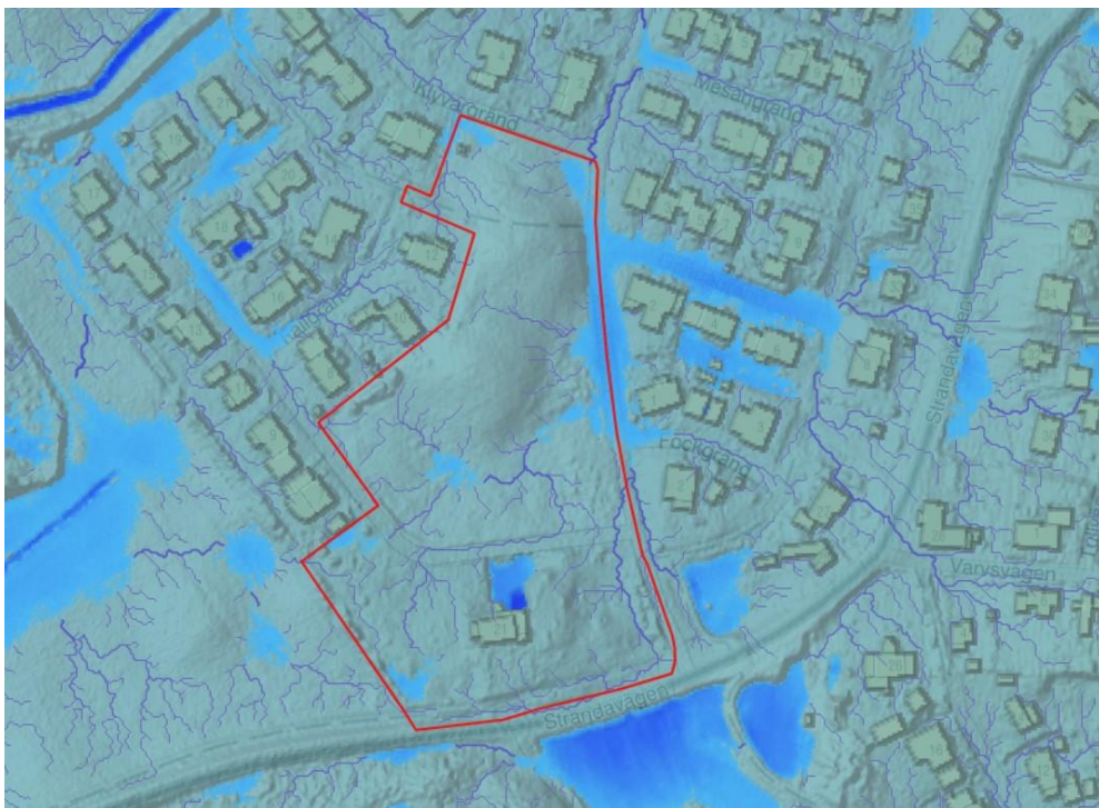
Figur 3-3. Befintliga lågpunkter inom och omkring planområdet, vilket markeras med röd linje. Ytligt vatten från planområdet avrinner mot lågpunkt i Mastvägen öster om planområdet. Vid händelse att vatten inte kan avledas via ledningsnät eller infiltrera rinner vatten vidare norrut.
