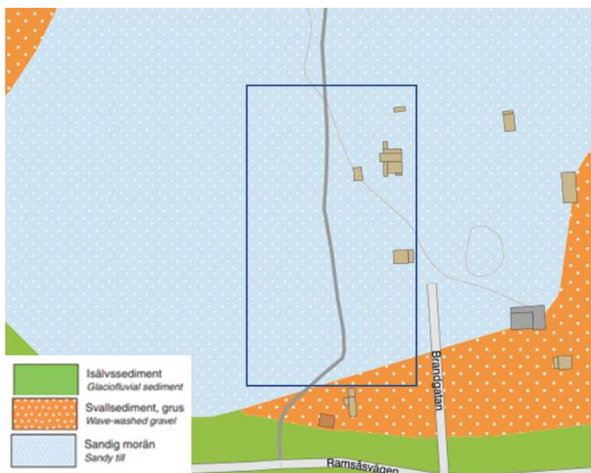
Figur 2. Utdrag ur SGU:s jordartskarta som visar att marken främst utgörs av sandig morän. Undersökningsområdet är ungefärligt markerat med blå figur.
