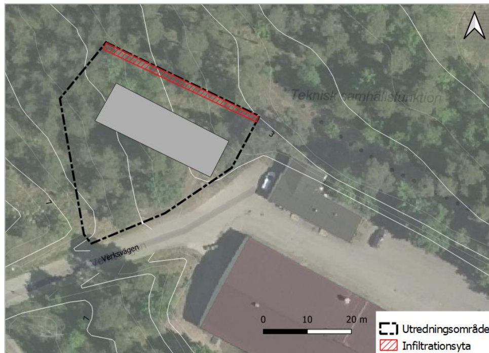
Figur 5. Föreslagen dagvattenhantering med infiltrationsyta
